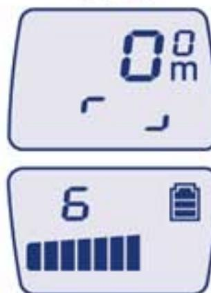
液晶パネルが<図2>を表示する時は、先に入力されたデータが残っていますので一度クリアしてください。
