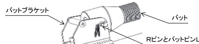
※バット取付部は、塩かみによる固着が発生しやすく、
